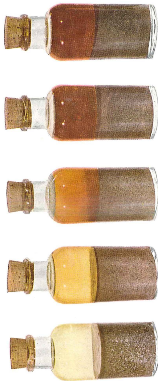
Fig. 18. Resultatet af humusundersøgelse af forskellige sandprøver. Proven til venstre er den rene, og den næste er også brugelig. Den midterste sandsort er dårligt egnet, medens de to til højre er uegnede, dersom farvningen skyldes humus.
