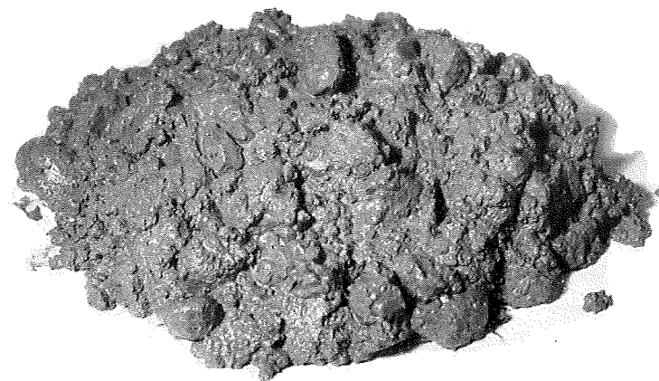
Fig. 27. God beton med passende forhold mellem mørtel og stenmængde. Stenene er dækkede, men man ser tydeligt, at de er der.
