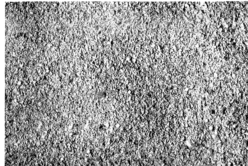
Fig. 11. Sand, der er for fint og enskornet. Det mangler grove korn og er derfor ikke særlig godt til beton.
