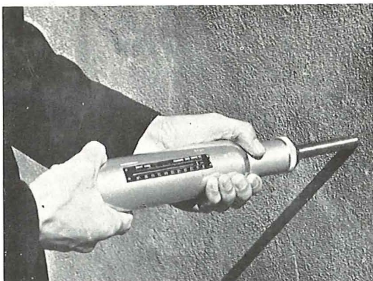
Fig. 52. Anvendelse af en betonprøvehammer.
