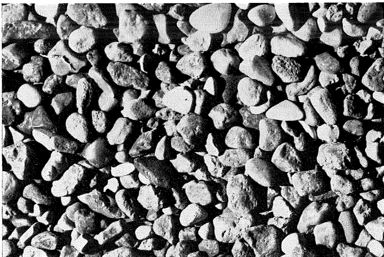
Fig. 13. Perlesten; de fleste korn kan passere 8 mm sigten, men ikke 4 mm sigten.
