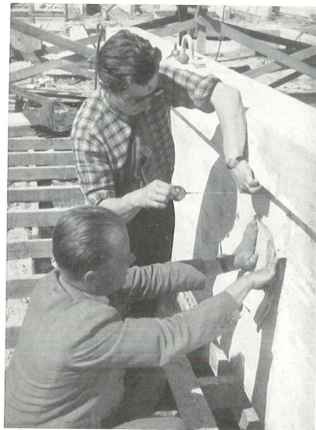
Fig. 51. Udførelse af kugleindslags- prøven.
